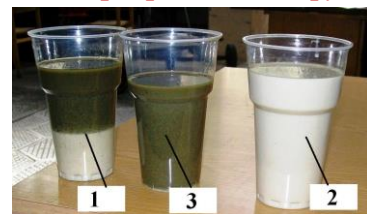
Исходные загрязненные и загнивающие СОЖ (слева) и их очистка и обеззараживание установкой «ЭКО-СОЖ» (справа): 1 - загрязненная СОЖ; 2 - очищенная СОЖ; 3 - извлеченные масла.
