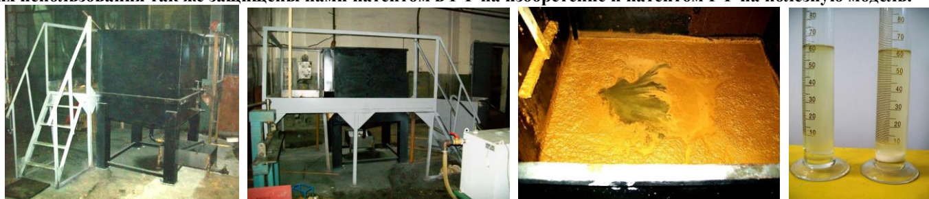
Рис.2. Участок обезвреживания (в Республике Беларусь) с баком - реактором «БР-2» объемом до 2 м 3 , процессы и результаты обезвреживания в нем отработанных СОЖ (фото справа).
